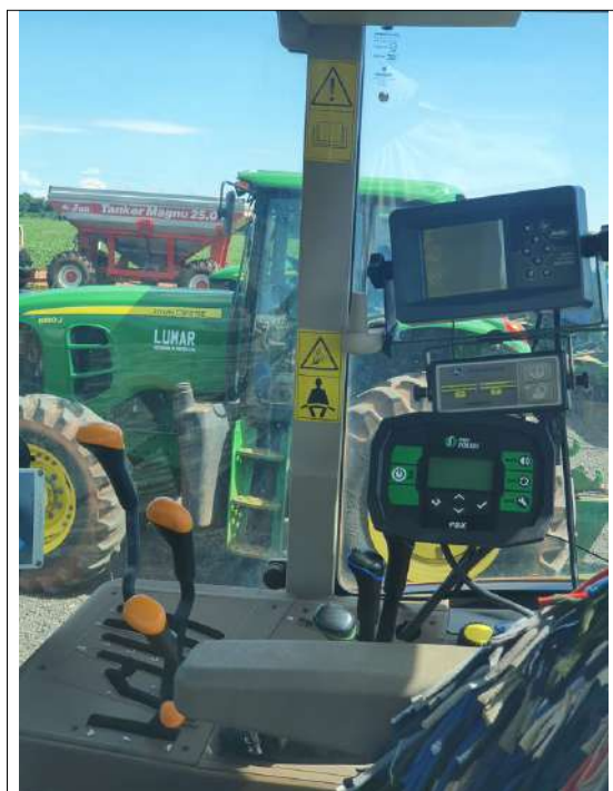
Figura 52 – Detalhes Instalação Pro-Solus - Vista 1.
