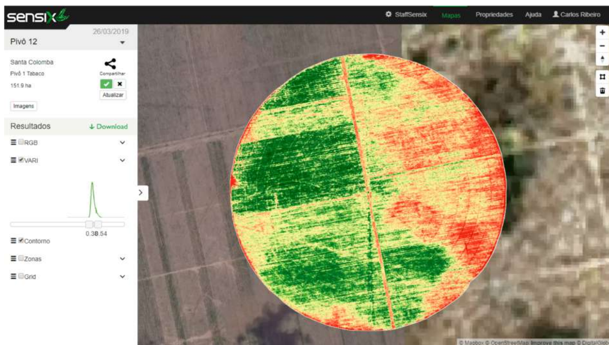
Figura 7 – Índice de vegetação VARI. Define a variabilidade de biomassa e atividade fotosintética para identificação de anomalias (doenças, pragas, estresse nutricional e hídrico).
